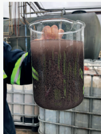
Separación de agua del lodo de depuración.
